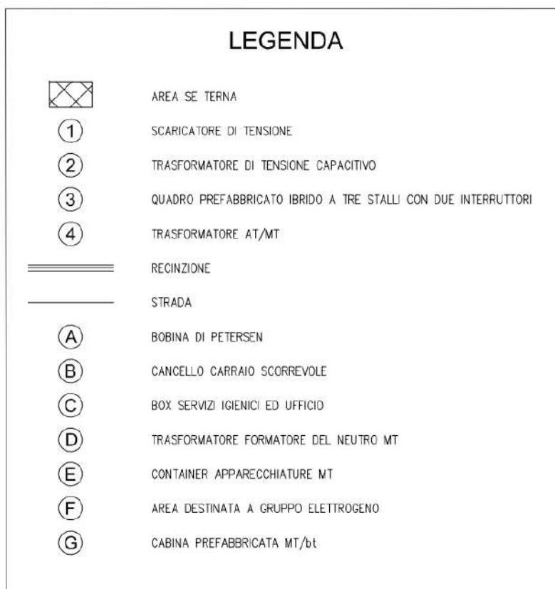
Figura 4.24: Cabina primaria Grillara: planimetria elettromeccanica
